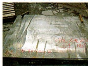
処理前 モリブデンインジウム付 (白っぽい箇所がインジウム)
