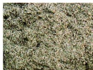
処理後 タantalのみに 専用のパレル(閉鎖されている) で化学処理にて精練している為 タantalのロスがない
